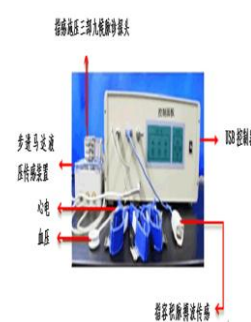
d. 指感施压寸关尺三部脉诊信息采集装置
